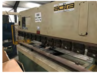
Adira kantpresse Type QH 6325 2500 x 63T, Cybelec cnc styring Pris DKK 49.000,-
