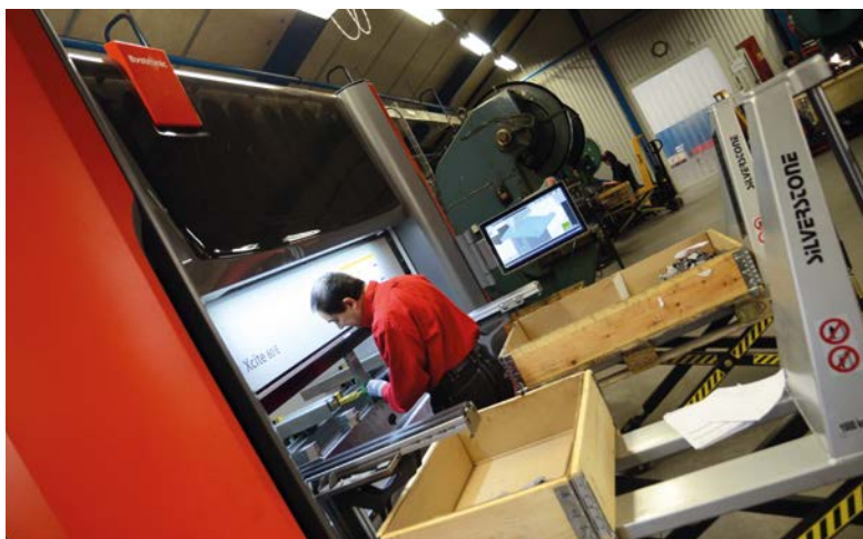
Snabbast i Sverige? EMAB i Forsheda har utökat maskinparken med en ny elektrisk kantpress som halverar produktionstiden. Majid Aghabecik sköter arbetet vid maskinen.
