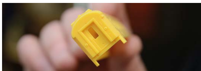
3D-printtekniken lämpar sig särskilt bra för små detaljer i lågserieproduktion. Flera material och färger finns att tillgå.
