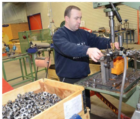
Exmo AB tar hand om all typ av efterbearbetning av plast- och gjutgodsprodukter, men även detaljer till bland annat fordonsindustri. Här utförs gängning av bottenplugg till oljeträg av Petro Marek.
