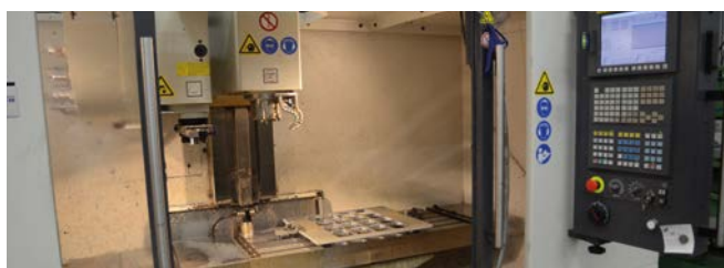
Med höghastighetsfräsning tillverkas även metallprototyper i exempelvis zink, aluminium, rostfritt och mässing.
