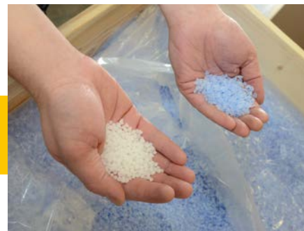
Formblåsning kan utföras med i princip alla slags konstruktionsplaster. Materialet är hållfast och återvinningsbart vilket innebär mindre påfrestning på miljön.
