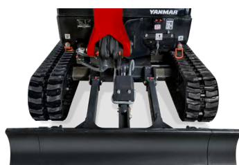
Understel kørt ud : 1320 mm
