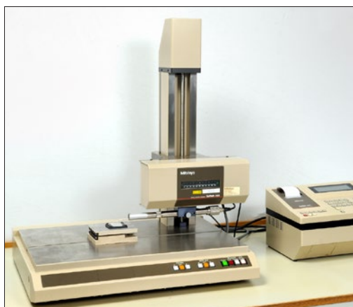
Instrument för kalibrering av ytjämnhetsnormaler.
