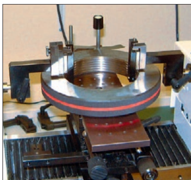
Kalibrering av gängring i längdmätbank.
