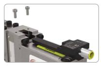
Abdeckung/Sensor abnehmen und Spannmechanismus freilegen, um den Öffnungswinkel einzustellen.
