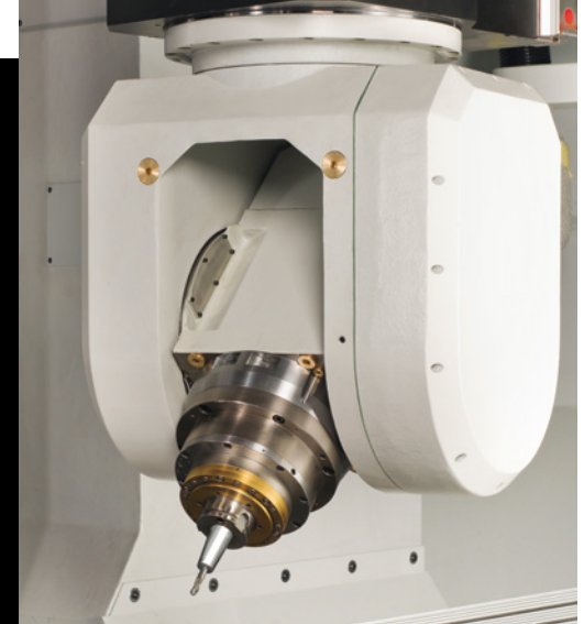
Nuova testa birotativa New bi-rotary head A = ± 110° C = ± 270°
