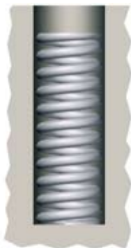
1. Planslipt med utvendig styring
