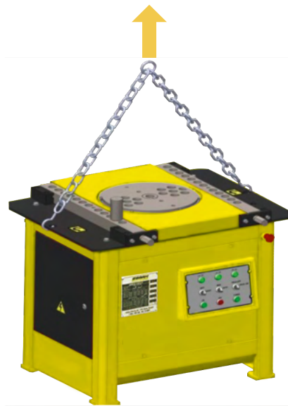
Fig 2. Løftning af bukkemaskinen.
