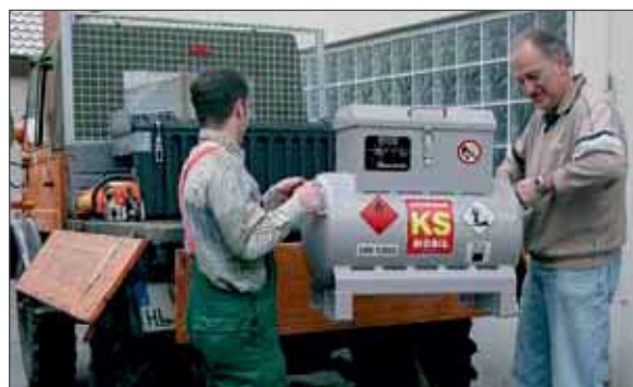
Håndtagene kan også bruges til løft med kran.
