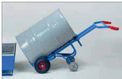
Tromlevogn model FK 306 med støttehjul til at løfte tromler op på og af opsamlingskar med en højde på op til 360 mm
