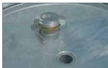
Indbygget påfyldningstragt med snavs-opsamlingssi og fastmonteret aftapningsstuds.
