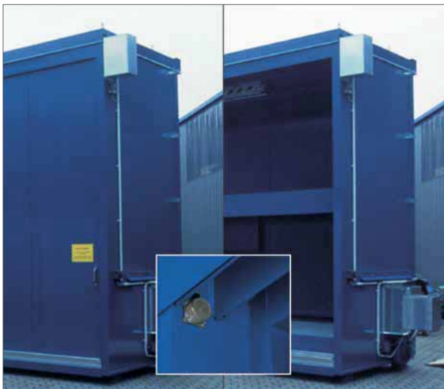
Dørlukningssystem, som automatisk lukker skydedøre i tilfælde af brand På billedet: Dørlukkeanordning (i galvaniseret kabinet) og eksplosionssikret dørholdermagnet
