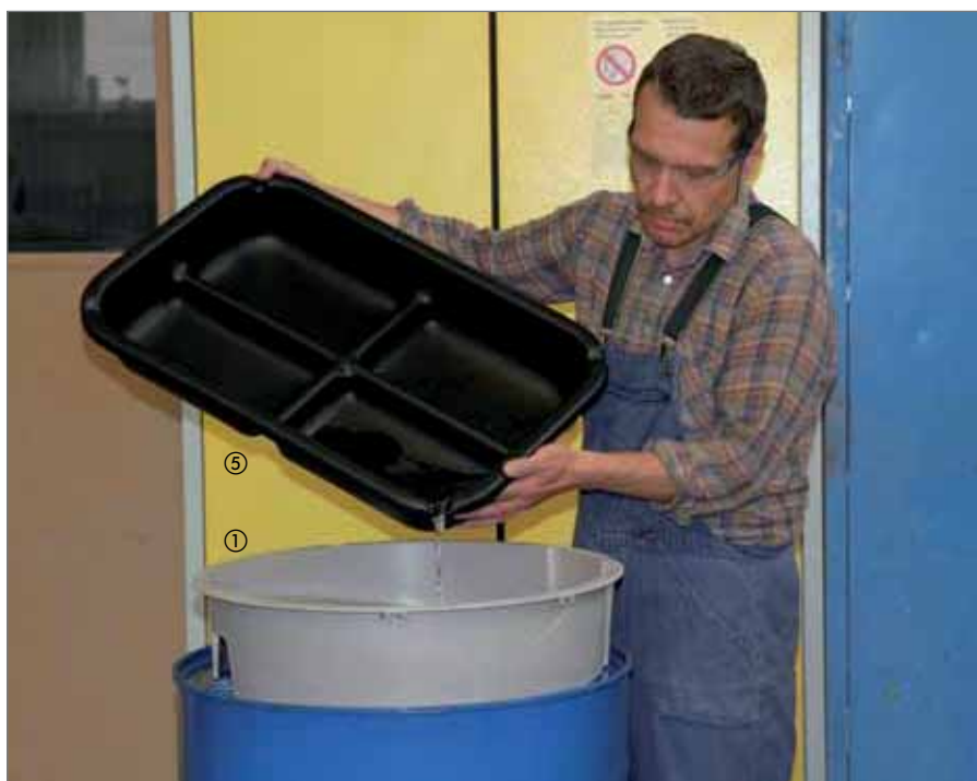
PE-opsamlingsbakke 20l med GFK-påfyldningstragt uden låg
