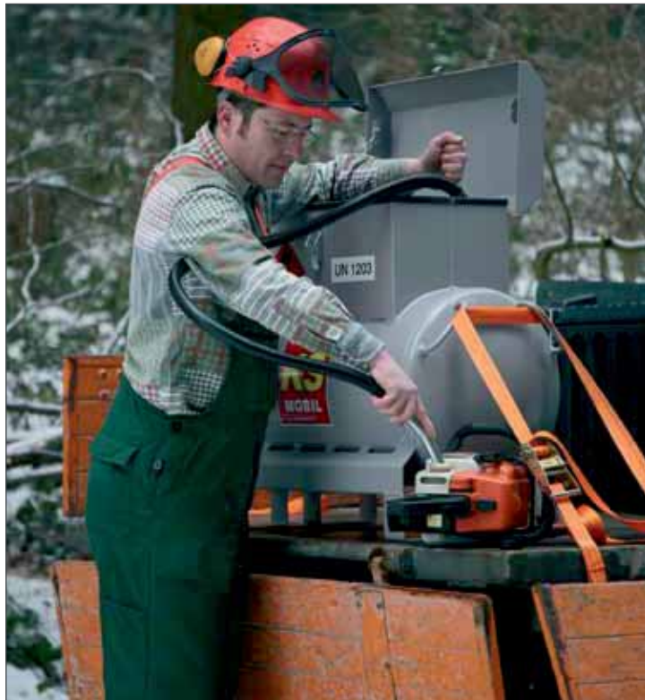
Mobilt brændstofanlæg med håndpumpe til let optankning på stedet
