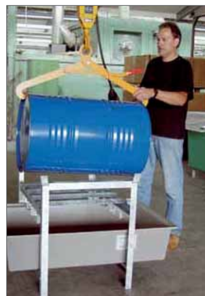
Tromletang til løft af liggende tromler, med håndbremse
