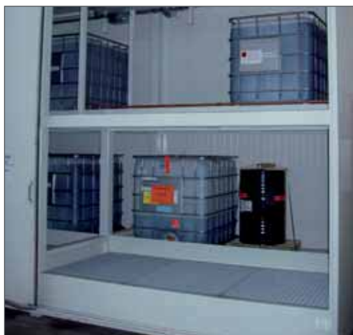
Termisk isoleret reolcontainer, betjeningsadgang fra to sider for KTC/IBC'ere
