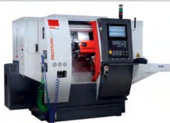
EMCO drejbænk E45 6300 o/min., drevne værktøjer C-Y-akser, 12 st. revolver
