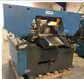
Trennjaeger aut. båndsav Type 350 A NC, 90° Ø400 mm 400x350 mm, trinløs skæreh.
