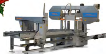
Meba båndsav ECO 335 15-150 m/min. frekv.regulering, Materialeførføring 5-2300 mm
