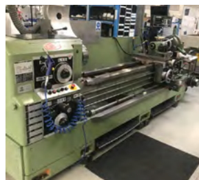
Tong-II drejbænk Drejelængde 2050 mm, boring 80 mm, pinelhøjde 265 mm
