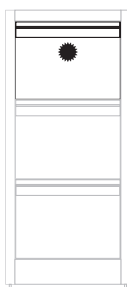
BE-400-Paper Låda anpassad för centrummatad pappersrulle. Torkrulle TORK M1 BASIC 1-L B 295 x H 220 x D 600mm. Passar i modulstorlek B 400 x H 880 x D 660mm.
