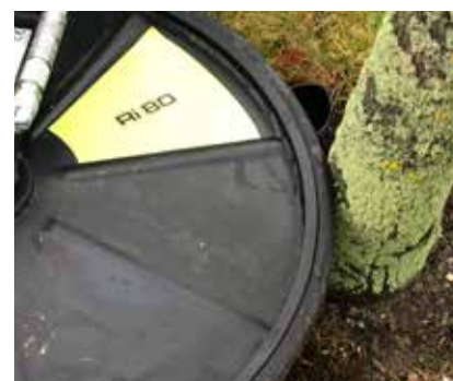
Gummibeskyttelse på tallerken forhindrer skader på redskab, planter og hegn.
