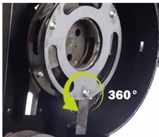
360° frit svingende knive (afviger ved overbelastning)
