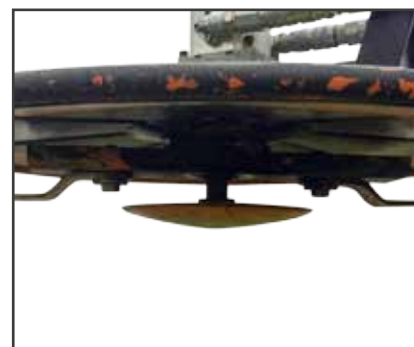
Slidtallerkenen forhindrer knivene i at ramme jorden under arbejdet
