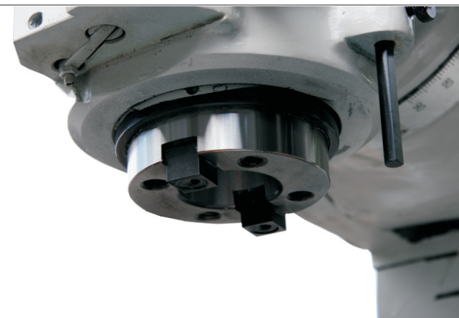
ISO40 spindel 100mm spindel med DIN2080 ISO40 konus
