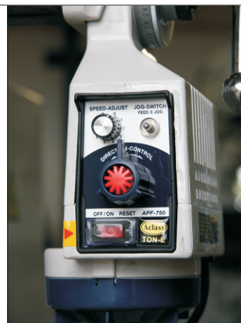
Tilspændingsmotor AClass APF-750 motorer med trinløs variabel tilspænding, kryb og ilgang
