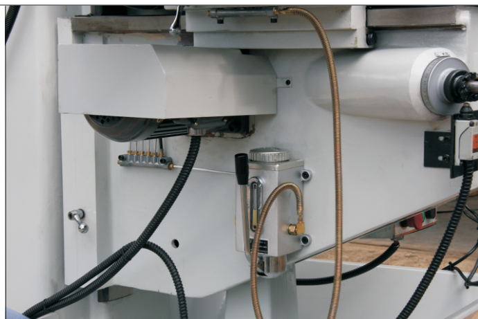
Centralsmøreanlæg Centralsmøreanlæg for spindler og vangeføringer
