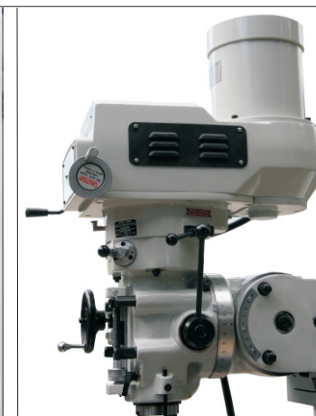
Vertikalhoved Lydsvag 5 Hk hovedmotor med borende spindel
