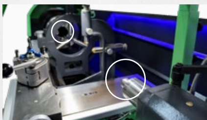
Drejning mellem 2 pinoler (MK-4)
