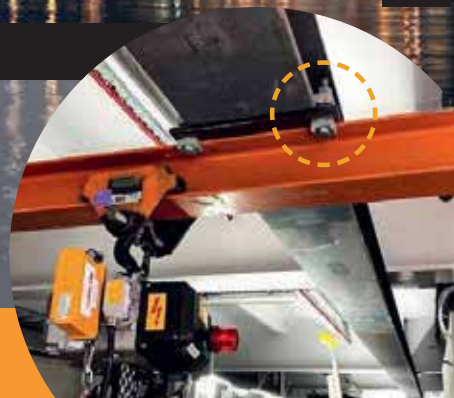
Bild Hisingsbron: Skanska Bild monterade klämplattor: Tunga Lyft AB
