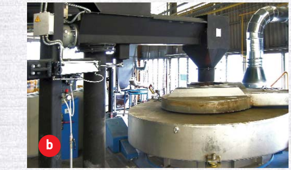
Alimentazione forno elettrico Screw feed electric furnace
