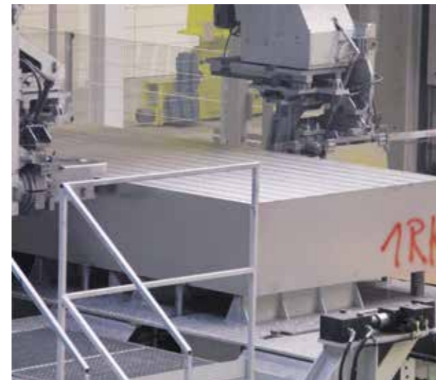
Rohbarren als Ausgangsmaterial
