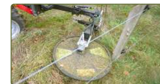
Kant-/Stolpklippare RI monterad.
