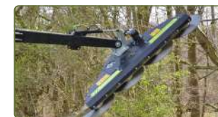
Grensåg LRS monterad. Hydraulisk klippvinkeljustering 110° (extrautrustning HXF 3302). Kräver 1 st dubbelverkande hydrauluttag.
