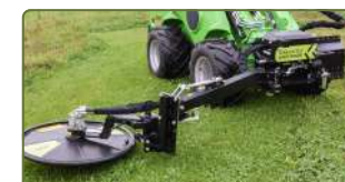
Kant-/Stolpklippare RI monterad.
