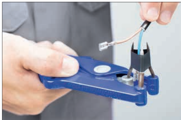
Hurtig og sikker montage med det 3 dornede ekspansionsværktøj.
