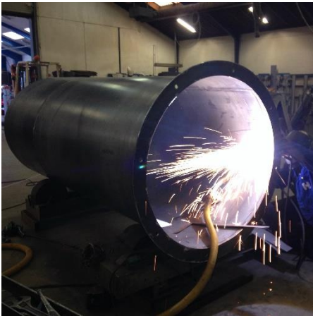
Billede 1: Valsning og svejsning af trykbeholder.
