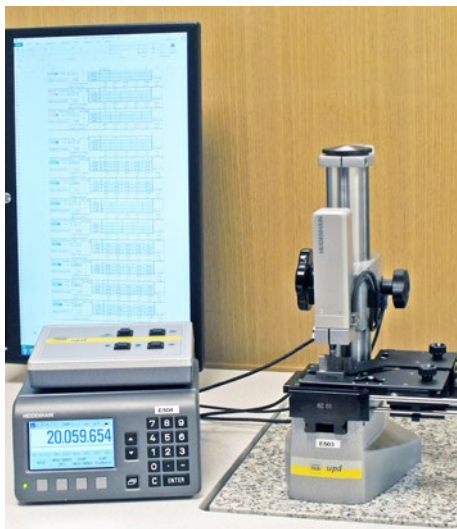
Kalibrering av passbitar i passbitskomparator.
