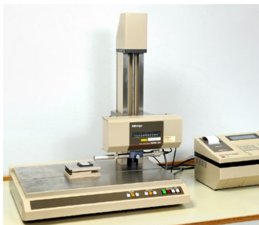
Instrument för kalibrering av ytjämnhetsnormaler.
