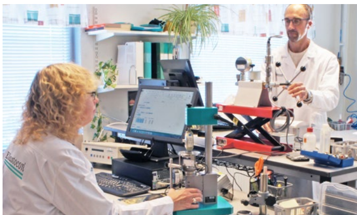
Det allmänna laboratoriet för kalibrering vid 23 °C. Utöver detta har vi ett konstantrum för kalibrering av längd vid 20 °C ± 0,5 °C, samt ett rum för temperaturkalibrering.
