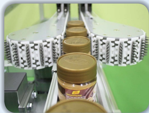
Klemløsning til f.eks. 90° vertikalt løft.
