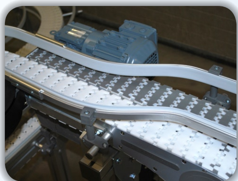
Problemfri overførelse fra bane til bane med minimal afstand mellem kæderne.
