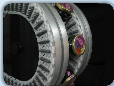
Vende emner på hovedet for f.eks. tømning af glas inden påfyldning.
