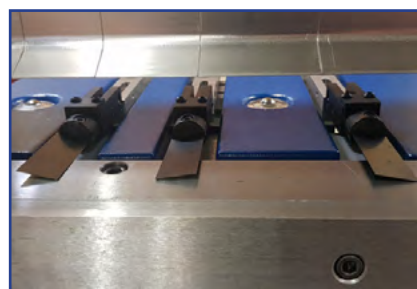
Massiv undervange & fjederfingre på bagstoppet
