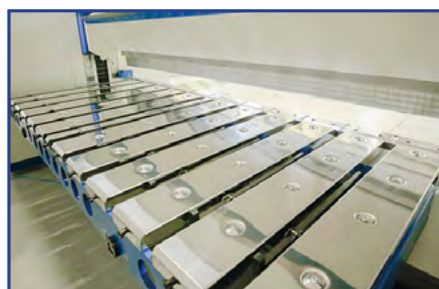
Beskyttelse i rustfrit stål til pladeanslag
