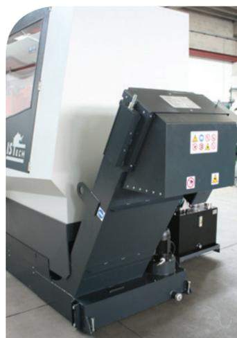
L'evacuatore trucioli, con un'altezza di oltre un metro, permette alla macchina di lavorare per più ore senza intervento dell'operatore. L'ampia bocca di scarico del truciolo (600 mm) e il sistema a catena consentono di trasportare in modo più agevole ed efficiente il truciolo al di fuori della macchina.
