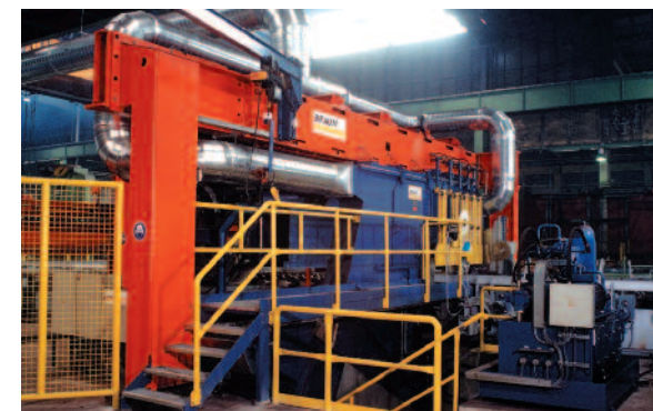
Fig. 16 Abrasive cut-off machine type TS 12 FP at BÖHLER-BLECHE, Mürzzuschlag-Höfnigsberg, Austria
