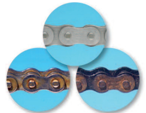
Renold Hydro-Service efter 14 dagars användning i saltvatten (5%)
