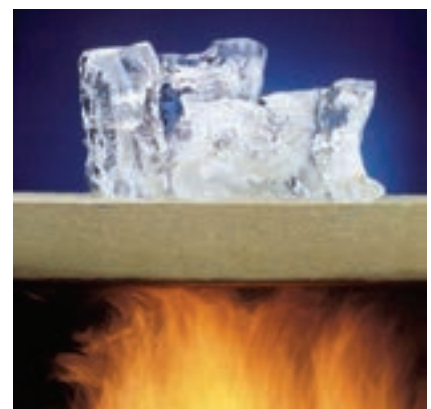
Stennull behåller sina egenskaper vid så höga temperaturer som 1000 °C och utgör därför ett gott passivt brandskydd.
