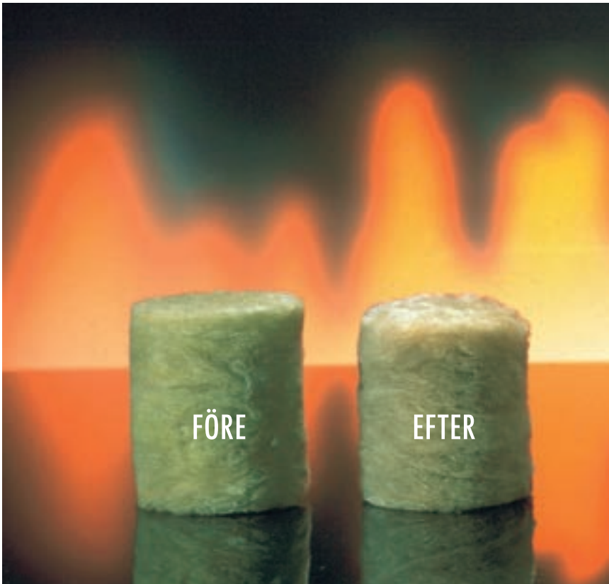
Paroc® Stenull står emot mycket höga temperaturer. Bilden visar ett exempel av PAROC® Stenull före och efter ett brandtest enligt EN ISO 1182, där testföremålet utsätts för en temperatur på 750 °C.
