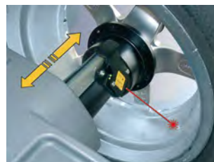
Intern laser og ekstern sonar, som måler hjulet og positionerer vægte.
