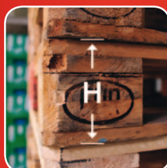
Forskellige pallehøjder - Ændring af skørte
