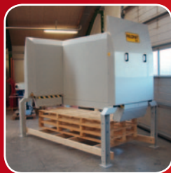
Forskellige pallebredder - Ændring af bagplade
