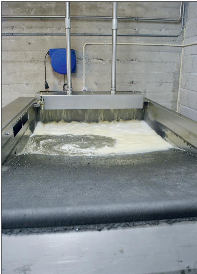
Det beskidte kølesmøremiddel starter sin tur gennem renseprocessen over båndfilteret. Når båndfilteret er fyldt, rulles en frisk dug frem.
