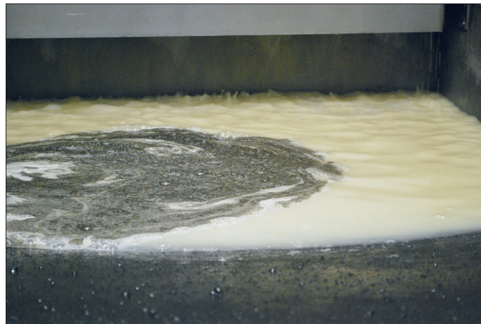
Båndfilteret frafiltrerer store oliepartikler samt flydespåner mv.
