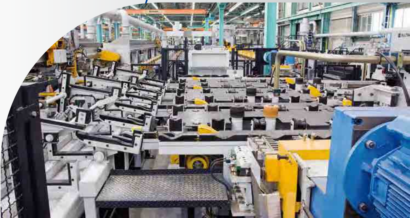
Säge- und Fasanlage für Messingprofile und -stangen Sawing and chamfering unit for brass profiles and bars
