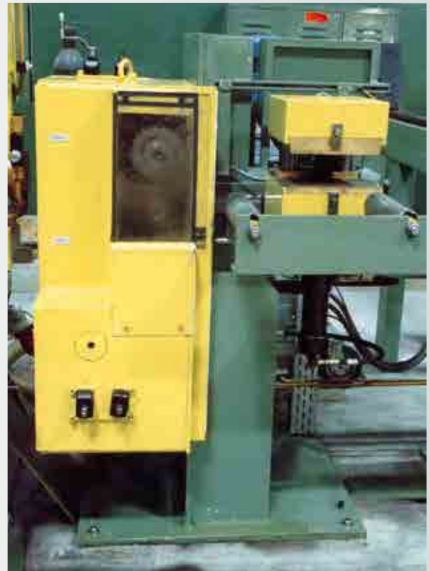
Anfräsmaschine für Messingprofile innerhalb einer Profilziehmaschine Milling machine for brass profiles arranged within a profile drawing machine
