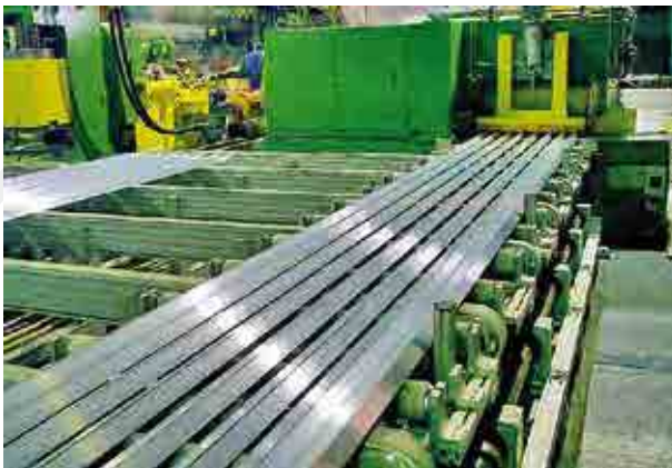
Strangpressenauslauf für Aluminiumprofile und -rohre mit Lagensäge
