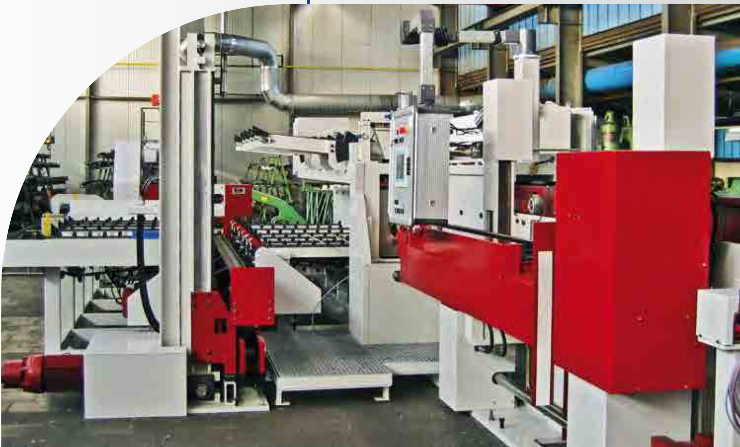
Profil-, Stangen- und Rohrziehmaschine für Edelmetalle Profile, bar and tube drawing equipment for precious metals
