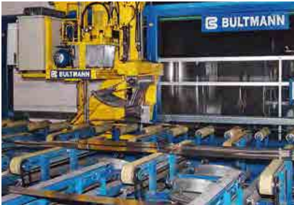
Puller im Strangpressenauslauf für Aluminiumprofile und -rohre
