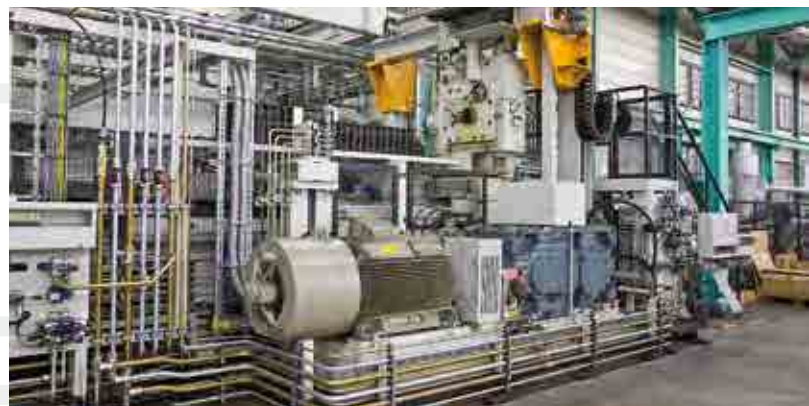
Ziehantrieb mit Zahnstange Drawing drive with toothed rack
