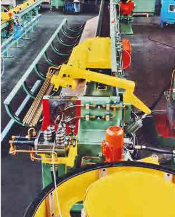
Profil- und Stangenziehmaschine mit Abhaspel, Vorrichtmaschine und Rotationsschere Profile and bar drawing equipment equipped with uncoiler, prestraightening machine and rotary shears
