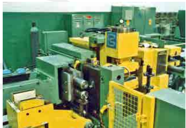
2-fach-Profil- und Stangenziehanlage für Messingprofile und -stangen u.a. mit Anfräsmaschine, Push-Pointer, Richtanlage, Lagensäge
