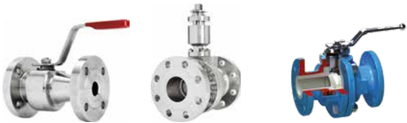
Kulventil Worchester – Flowserve 51-55-serien 819-829-serien Flänsad kulventil i firesafe-utförande. Fullt genomlopp eller reducerat utförande. Syrafast eller kolstål. Flänsar. DN15-250 PN16/40 ANSI150/300
