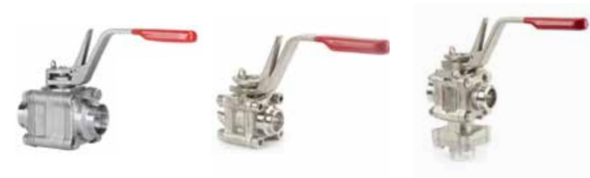
Kulventil Worchester – Flowserve A44/A459-serien Originalventilen i tredelat utförande. Långa/korta svetsändar samt gängad anslutning. Syrafast eller kolstål. DN8-150
