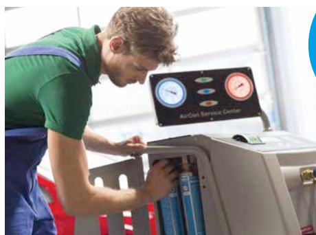
Standard på ASC 1300 G: fugtfrit opbevarings- og tilførselssystem til ny olie og UV-sporstof
