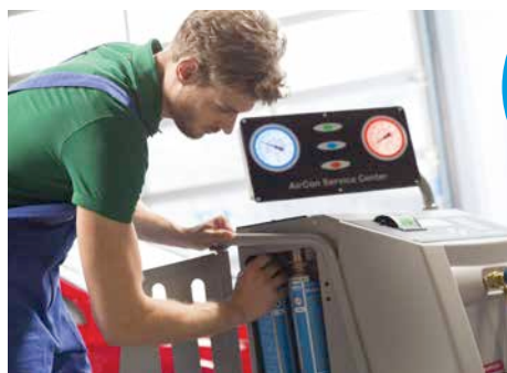
Standard på ASC 2300 G: fugtfrit opbevarings- og tilførselssystem til ny olie og UV-sporstof
