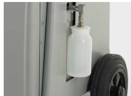
Spildolieflaske placeret på vejecelle, enestående for basismodeller
