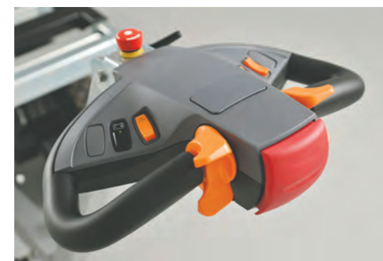
ST 1300 Trolley har et styrehåndtag, der gør det nemt at manøvrere.
