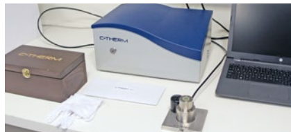
TCi – en termisk konduktivitetsmätare från C-Therm, som mäter värmeledningsförmågan.
