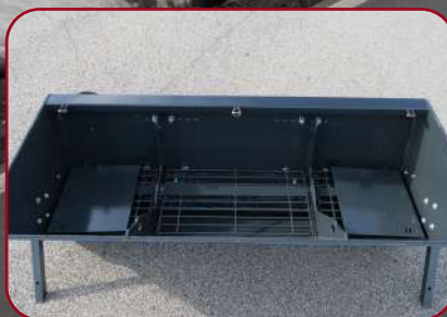
Öppningsbara skyddsgaller och spidarregleringsplåtar
