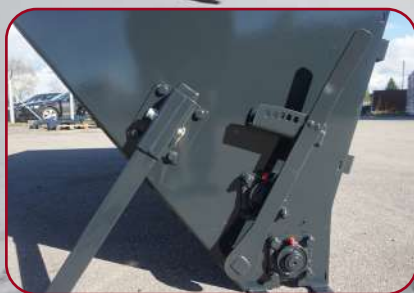
Stöbren och reglering av utmatning
