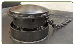
Slittallrik under kedjemagasinet.
