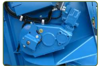
Hydrauliskt driven reversibel bottenmatta
