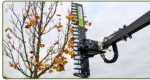
Häckklippare HS monterad. Vänsterhängd modell finns t.ex. till teleskoplastare, anges vid beställning.
