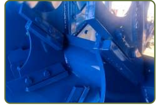
Valsarna skyddas av smatterkoppling
