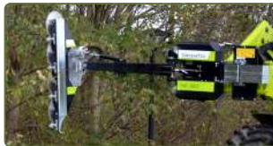
Grensåg LRS monterad, extrautrustad med motviker.
