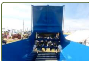
Dubbelverkande hydraulisk giljotindörr
