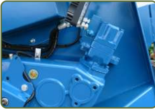
Hydraulmotor och övertrycksventil
