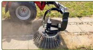
Ogräsborste BR för mekanisk ogräsbekämpning på hårdgjorda ytor.
