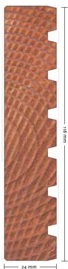
ThermoWood Terrassebrædt 24 x 118 mm Høvlet 4 sider, med riller på bagsiden.
