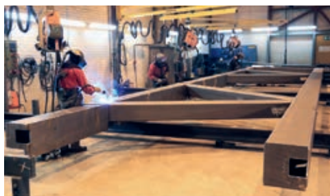
Fackverkens svetsades samman till två halvor i verkstaden och målades färdiga i Peräseinejoki och transporterades sedan med bil och färja till byggsplatsen i Stockholm.
