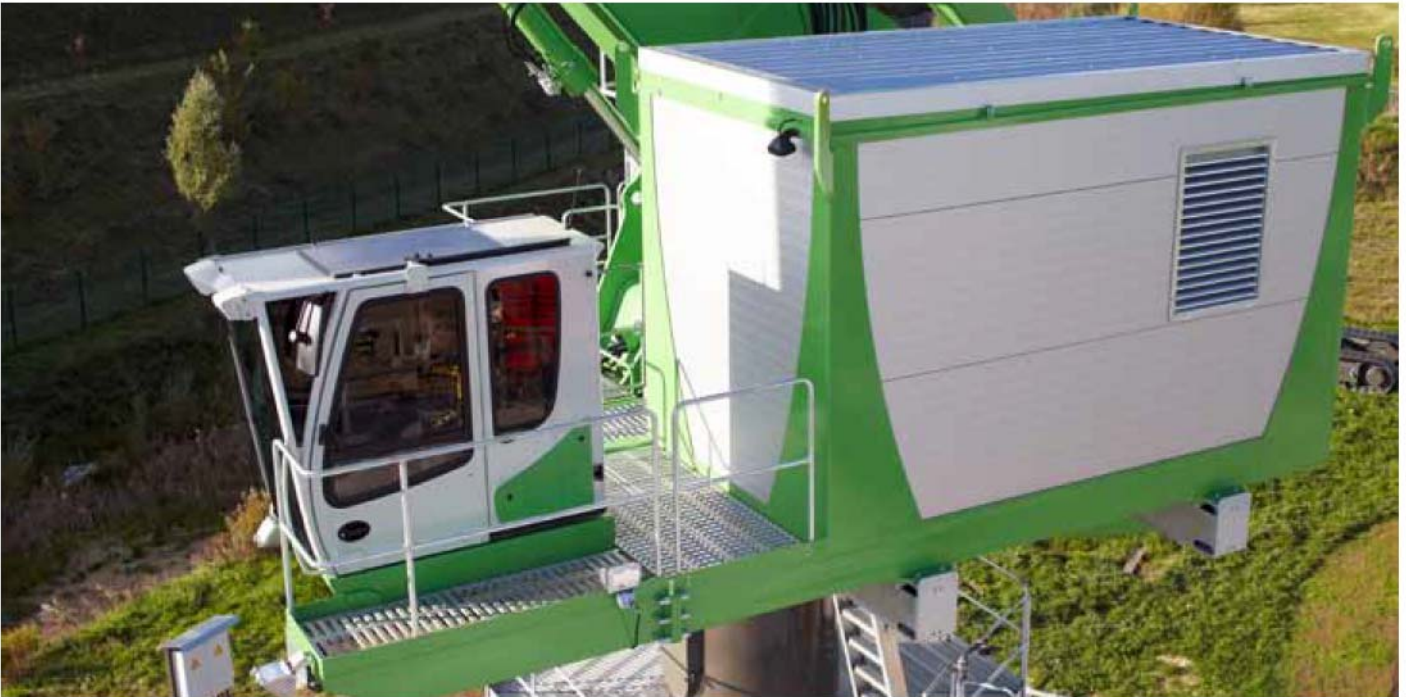
Begehbare PowerPack-Einheit Walk-in PowerPack unit
