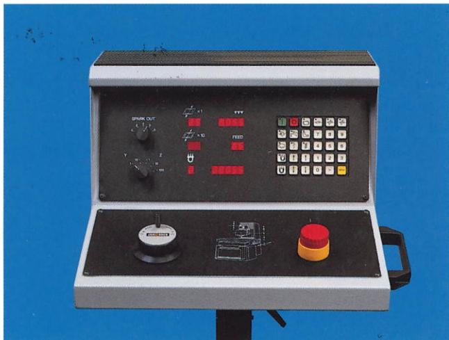
Den øvre sektion af betjeningspanelet indeholder et numerisk tastatur for inddatering af bearbejdningsdata samt alle basis betjeningselementer for automatisk og manuel drift af maskinen. Også vælgekontakten for automatisk udgnistring 0-8 overløb efter gennemkørt program samt akse-omskifter for manuel vertikal- og tværbevægelse er placeret på dette panel.
