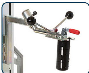
Rullexpander för att lyfta och rotera rullen 90°
