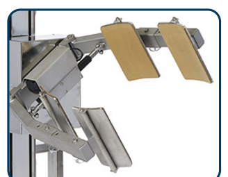
Drivet klämverktyg för vridning av fat/rollar
