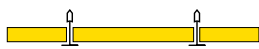
Glasuld er et af de materialer, der er mest modstandsdygtig overfor fugt. Derfor er loftplader af glasuld dimensionelt stabile og forbliver flade, selv i miljøer med en høj eller varierende luftfugtighed.
