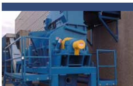
Granulator Grizzly M80 220 kW (300 HK) til granulering af RDF, elektronik og dæk
