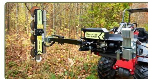
Grensåg LRS 1402 monterad.
