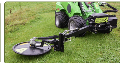
Kant-/Stolpklippare RI 80 monterad.
