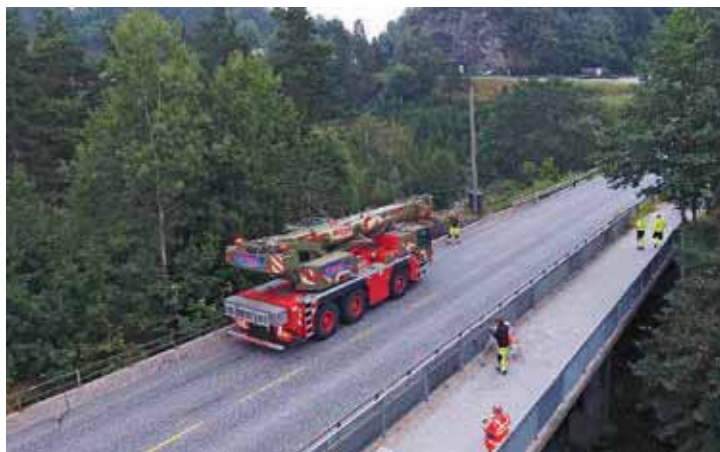
Figur 5: Belastning av Sagstu bru med en tung brannbil på midtspenn.
