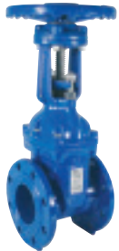
Serie 06/89 Flangeventil med stigende spindel og håndhjul Håndhjulet kan erstattes med en aktuator Kort byggelængde DIN F4 EPDM-skyder Duktiljern DN50-400
