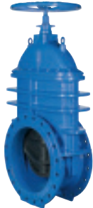
Serie 06/84 Flangeventil Kort byggelængde DIN F4 NBR-skyder Spindel af syrefast stål AISI 316 Duktiljern DN40-1000 Fra DN 450 med ISO-topflange
