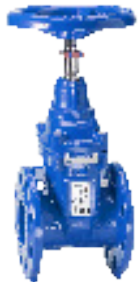
Serie 06/84 Flangeventil Kort byggelængde DIN F4 NBR-skyder Spindel af syrefast stål AISI 316 Duktiljern DN40-1000 Fra DN 450 med ISO-topflange
