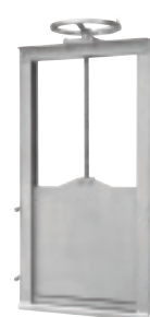
Serie 772/7172 Kanalmonteret skydespjæld Gennemstrømning fra én side til og med 1000 X 1000 mm, i større størrelser fra begge sider Med ikke-stigende spindel Rustfrit stål AISI 304 200 x 200 mm - 2000 x 2000 mm
