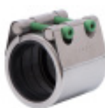
Series 745/20 Repico Slip kobling Universal og trækfast for alle rørmaterialer Rustfrit stål AISI 316 NBR eller EPDM DN15-600
