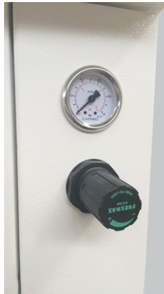
Controllo pneumatico del tampone elettronico Pneumatic control for electronic pad Control pneumatique du patin électronique
