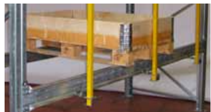
Genomskjutningsskydd Säkerhetsanordning som förhindrar lastpallar att falla ner på baksidan av ställ.
