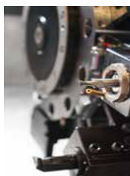
Fraise à perçer et à fileter Gewindebohrung Fräser Drilling and tapping milling cutter
